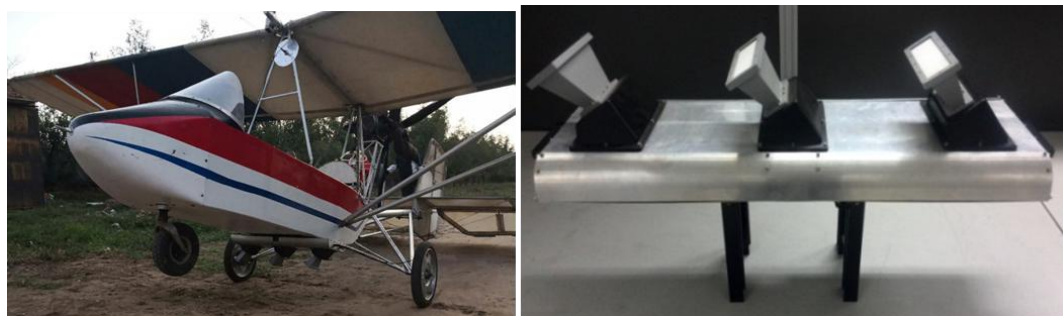
(a)蜜蜂飞行平台及搭载的 Ka 干涉 SAR
